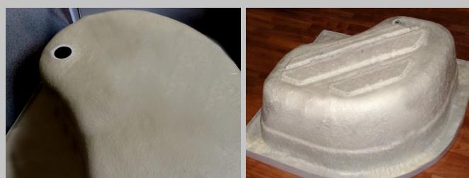
Дно поддона **не имеет усиления** вообще или усилено рееками. При слабом усилении дна поддона или его отсутствии, есть вероятность прогиба под тяжестью человека, отслоение пластика и **разрушение поддона.**
