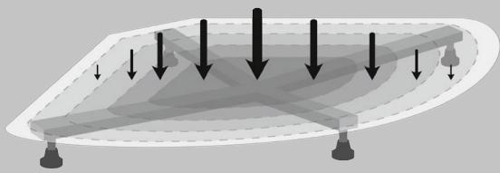
Отсутствует центральная опора - существует возможность **прогиба и разрушения поддона** во время эксплуатации.
