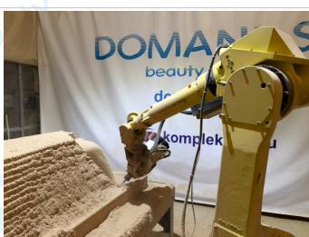
Формы фрезеруют **на станках ЧПУ**
